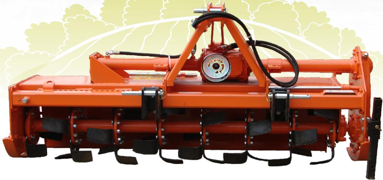
**Verschiebbare mittlere Bodenfräse, 4 - Gang Getriebe, Zahnradseitentrieb bis 75 PS.
